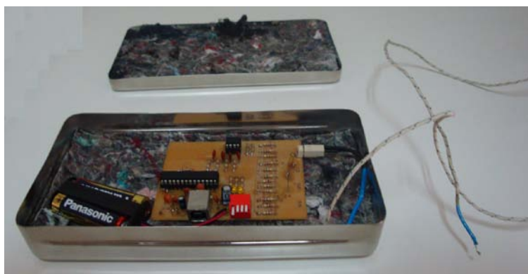
Figura 26 - Protótipo acondicionado dentro da caixa protetora com a manta isolante.
