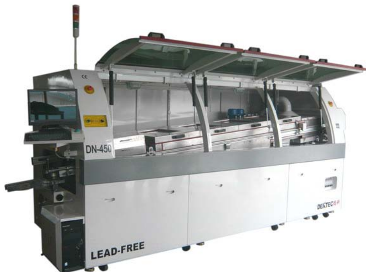
Figura 12 - Máquina de solda automática. Fonte: Dentec.
