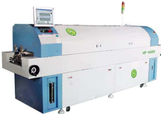
Figura 11 - Exemplo de forno de refusão. Fonte: Madell Technology Corporation.
