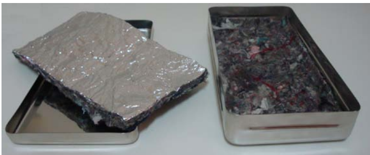
Figura 22 - Caixa inox e manta isolante utilizada como proteção térmica.
