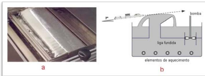
Figura 16 - Sistema de soldagem de onda plana, também conhecido como onda simples ou onda lambda. (a) Foto e (b) Corte explicativo. Fonte: www.ami.ac.uk .
